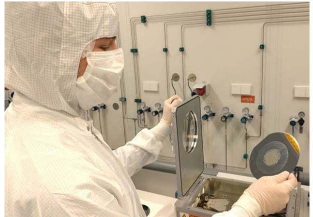
Wafer mit supraleitenden Qubits in der Fabrikation
