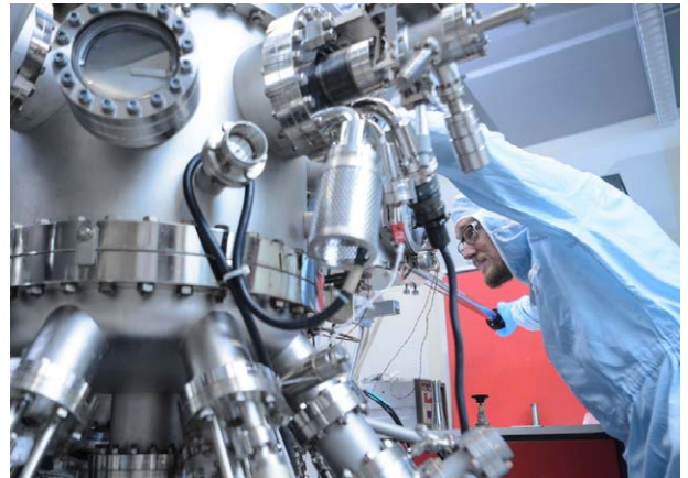
Halbleiterwachstum mittels Molekularstrahlepitaxie
