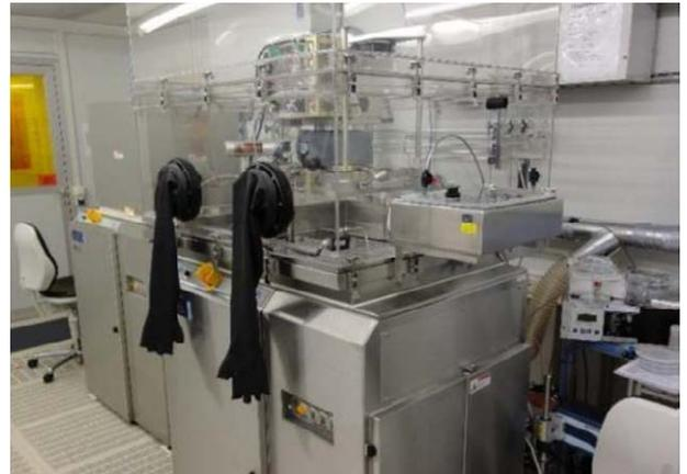
Optimiertes Atomlagen-Beschichtungssystem zur Herstellung von Niobnitrid-Nanoschichten im Reinraum des Leibniz-IPHT
