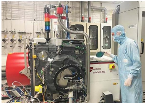
Beladen einer Ionenstrahl-Ätzanlage zur Bearbeitung von LiNbO<sub>3</sub>-Wafers
