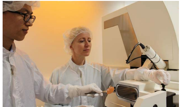
Prof. Dr. Isabelle Staude (rechts) und MUYI Yang (links) bei der Herstellung von Galliumphosphid-Nanostrukturen mittels Elektronenstrahlolithografie
