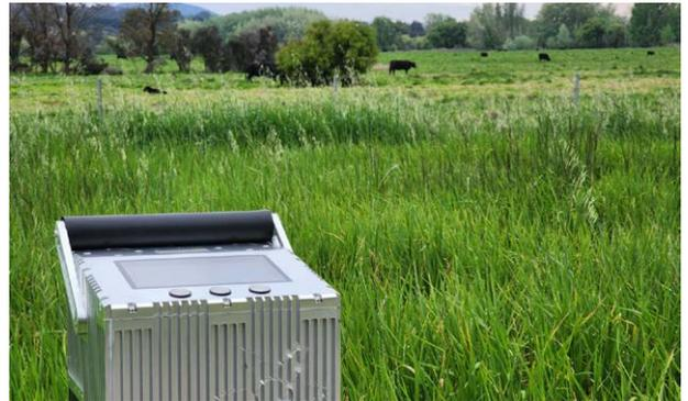
Demonstrator des Quantengravimeters zur Bestimmung der Grundwasserneubildung
