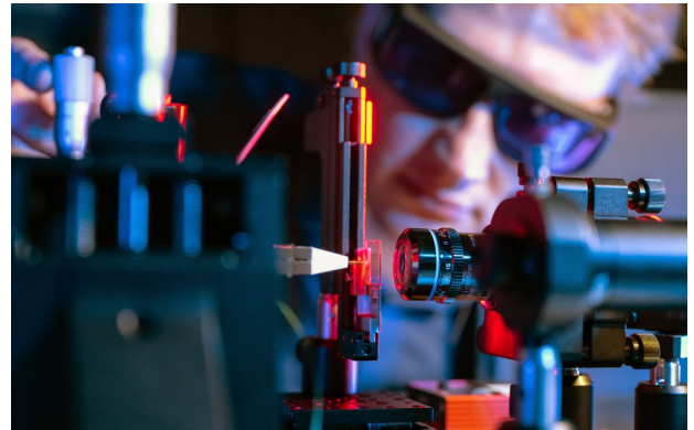
Justierung eines optischen Chips mit einer Quantenlichtquelle
