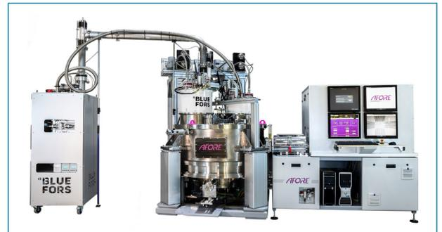
Vermessung von Qubits auf großen Wafern bei Temperaturen von  $-271\text{ °C}$
